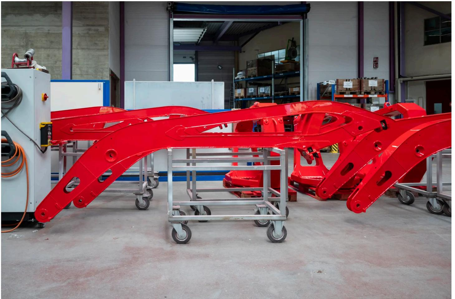
Ces pièces se montent sur les dameuses de pistes de ski et accueillent un treuil de Plumettaz pour s'assurer lors de travaux dans les pentes abruptes.
