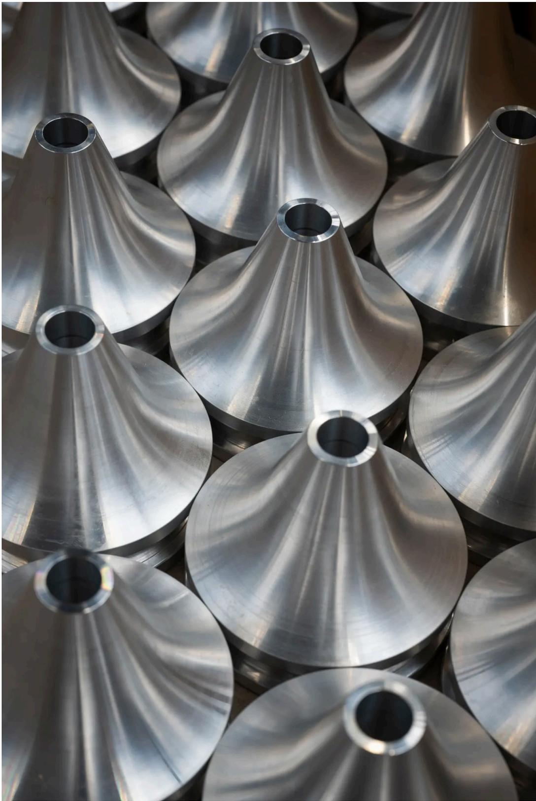
Parmi les innombrables pièces fabriquées à Bex, ces pièces d'aluminium servent à l'injection d'air au moment de la pose d'un câble de télécommunication. Une technologie développée par Plumettaz.
